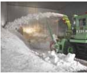
雪米の蔵内に運搬した 雪をロータリー車で 固めている様子
